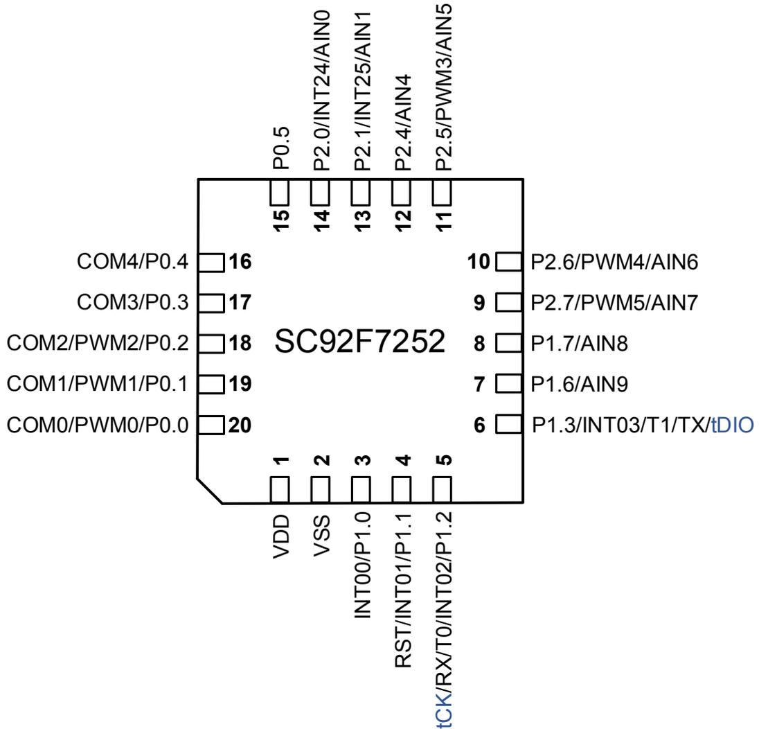
SC92F7252 管脚配置图 (QFN20)
