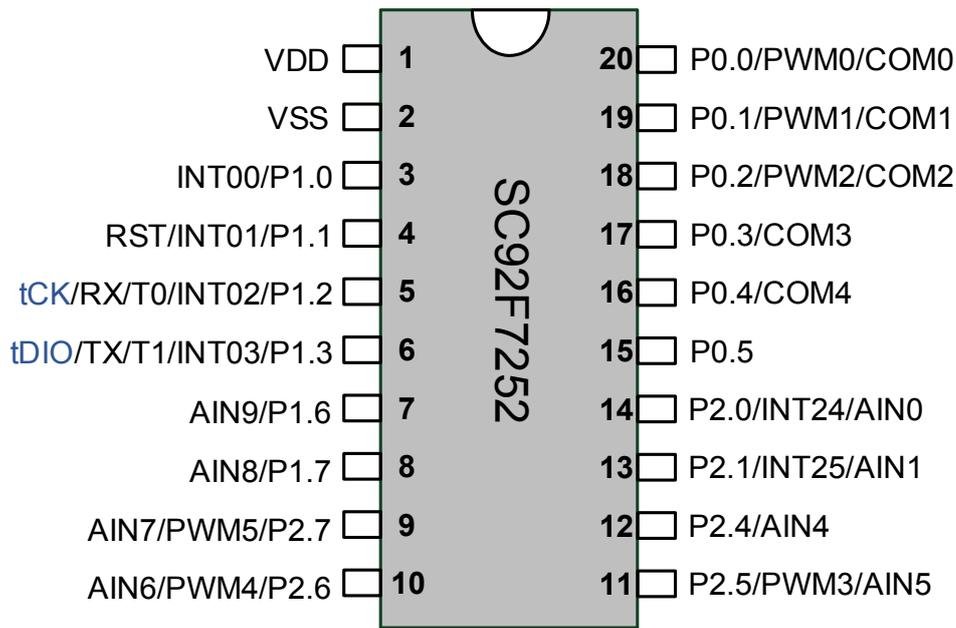
SC92F7252 管脚配置图 (TSSOP20、SOP20、NSOP20)
